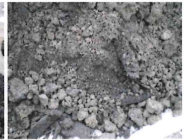
Rocky slag fill spoils, heavy petroleum odor
