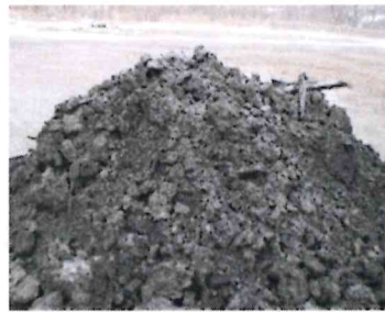
Rocky slag fill spoils, heavy petroleum odor
